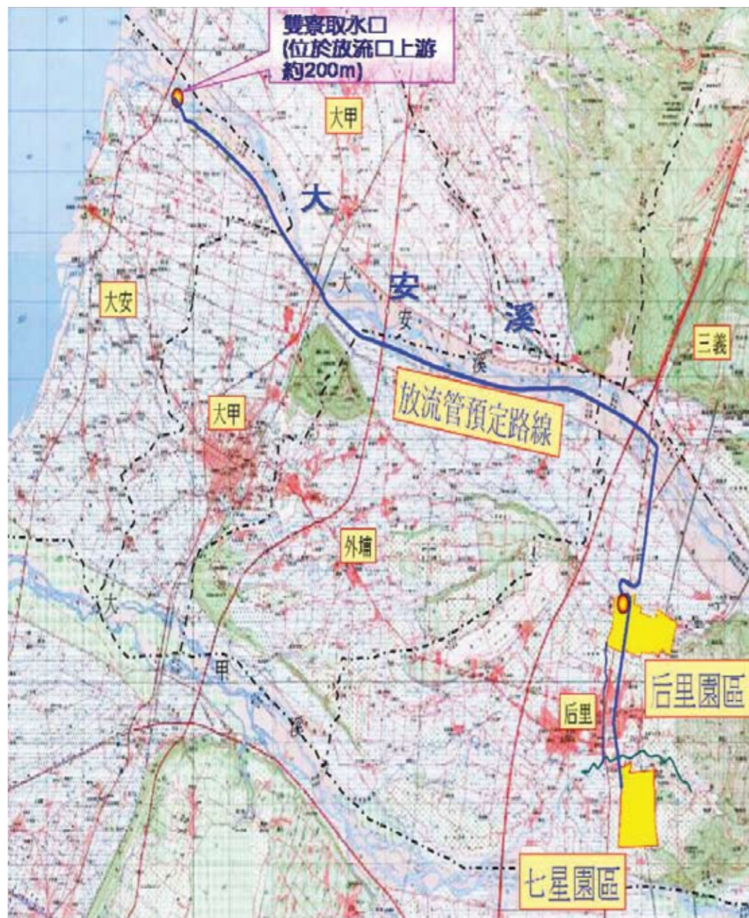
圖九 后里基地（含后里及七星農場）放流管配置示意圖
