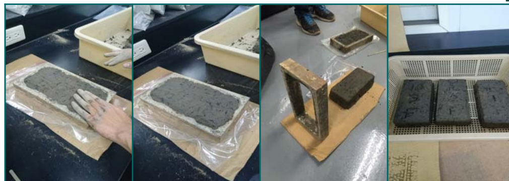
再利用廠商之磚窯廠進行實際測試過程
