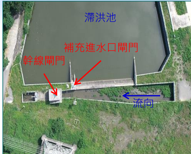
颱風來臨前：調節滯洪池水位至呆水位
