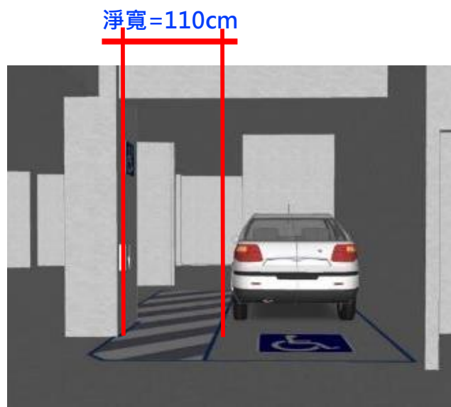
柱子及地面設置無障礙 停車位標誌
