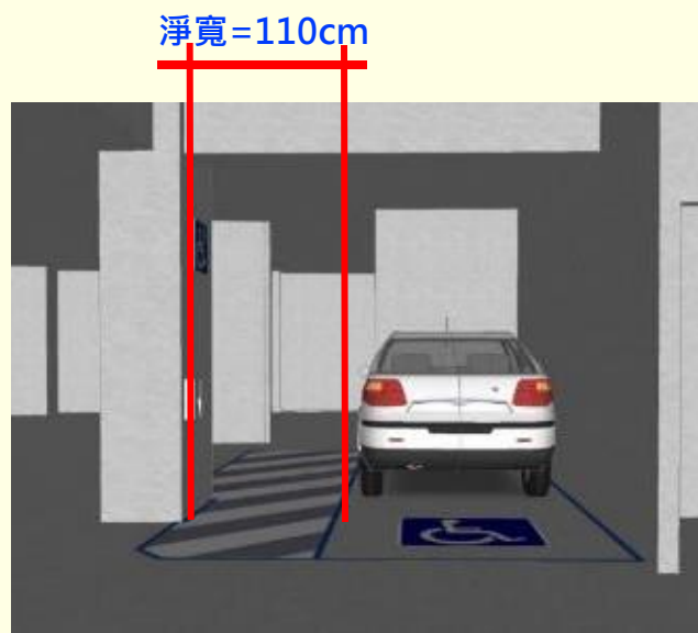
柱子及地面設置無障礙 停車位標誌
