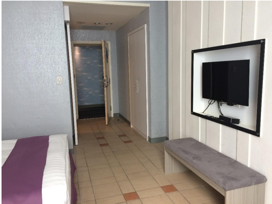
客房內通路寬度不得小於120公分方便輪椅使用者行進及迴轉
