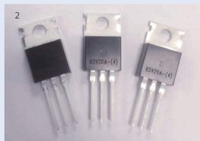
1. 氮化鎳功率磊晶片 2. 氮化鎳功率電晶體
