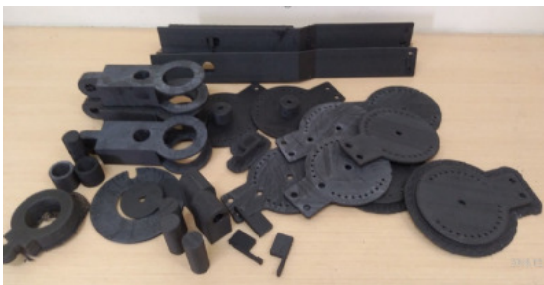
▲暨南大學研究團隊—利用 3D 列印設計打樣外骨骼機械人輔具
