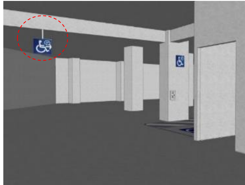
車道上方設置無障礙停車位引導標誌
