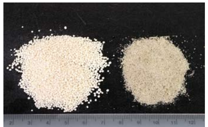
細砂(右)結晶成長後呈現飽滿圓潤的FBC晶砂(左)
