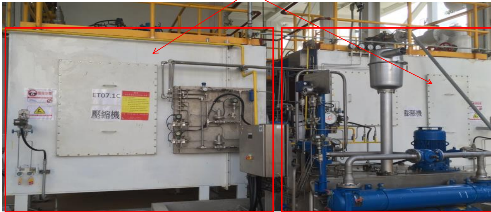
透平機內部填塞及外殼包覆
